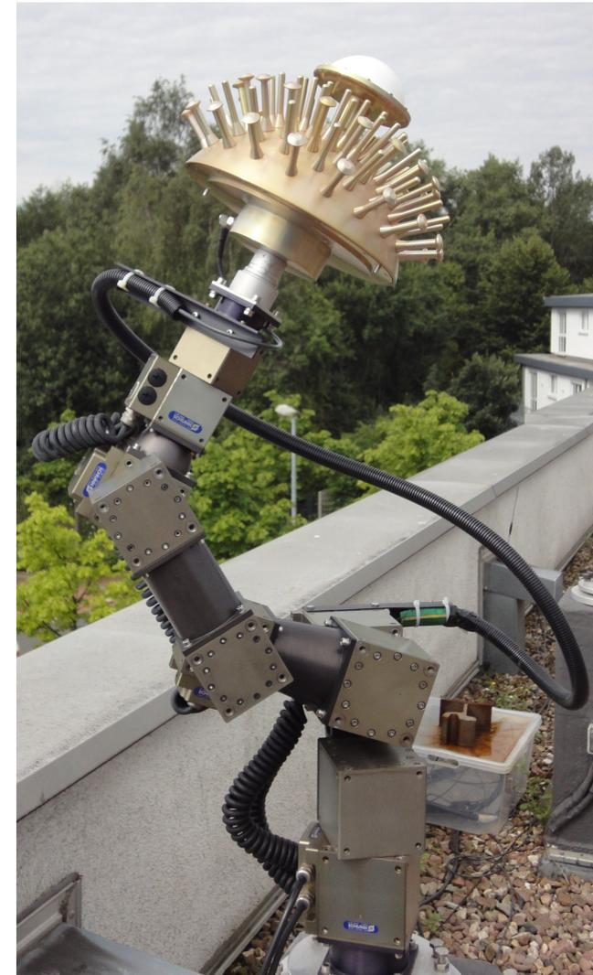
Geo++ Roboter mit TPSPN\_A5 NONE
