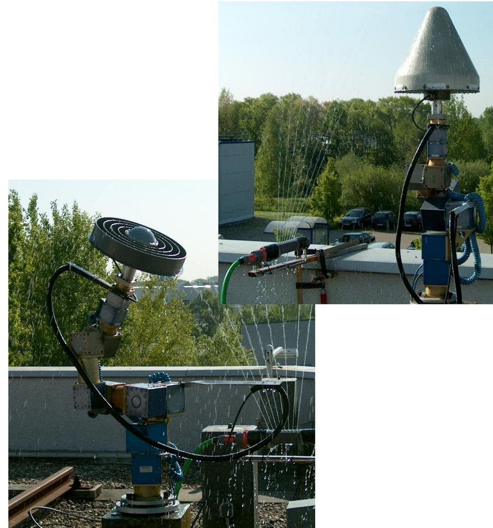
Wassersprenger während ASH700936D\_M NONE Antennenkalibrierung
