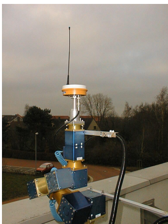
Abb. 4: DSNDGU_002_UHF* während absoluter Kalibrierung mit Roboter
