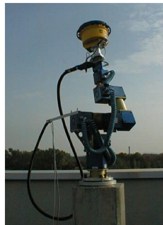
Abb. 9: TRM4800 während absoluter Kalibrierung auf Roboter
