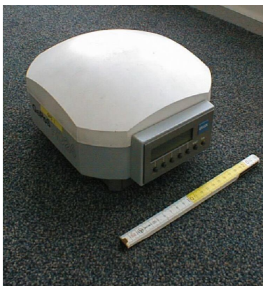
Abb. 8: Integriertes Antennen-/Empfängersystem CZJRD24*
