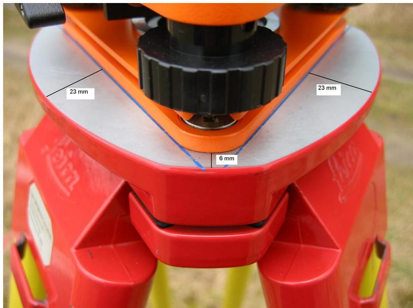
*Abb. 9: Kontrollmaße bei zentrischer Position Freiburger Dreifuß auf Leica GST120 Stativteller*
