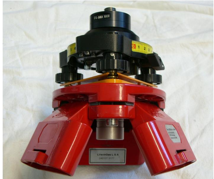
Abb. 8: Gesamte +SDF Konstruktion mit DIN-Zapfen Adaption für Roboter
