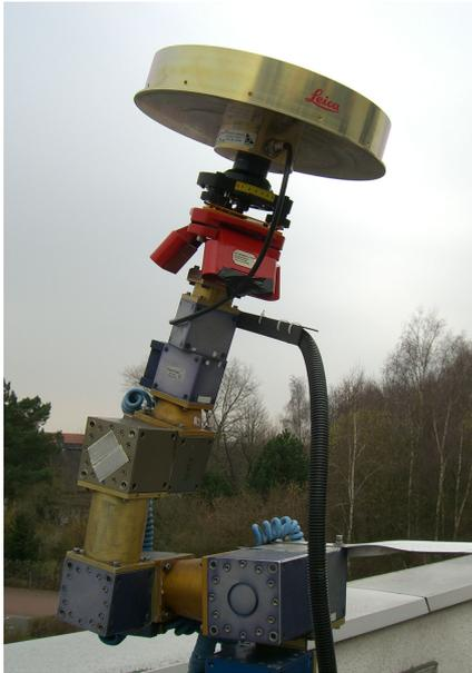
Abb. 10: Leica Antenne mit +SDF Unterbau auf Roboter
