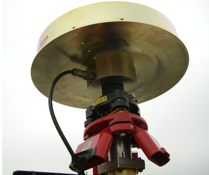
Abb. 11: Leica Antenne mit +SDF Unterbau: Nordausrichtung Antenne
